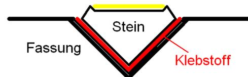
Idealfall einer Verklebung. Der Stein passt genau zur Fassung. Maximale Klebefläche – optimale Haftung.
